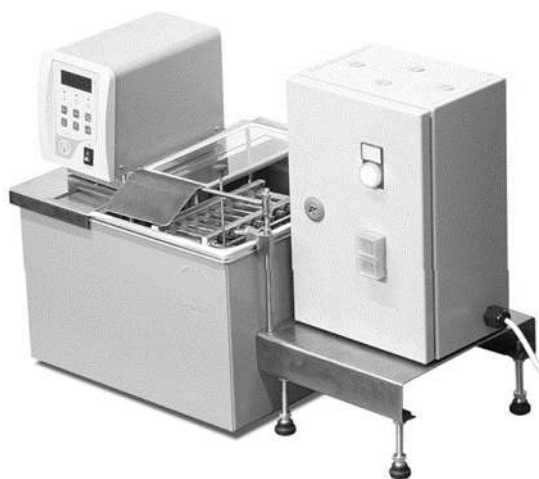
Рисунок 2 – Устройство контроля термоустойчивости УКТ-150
