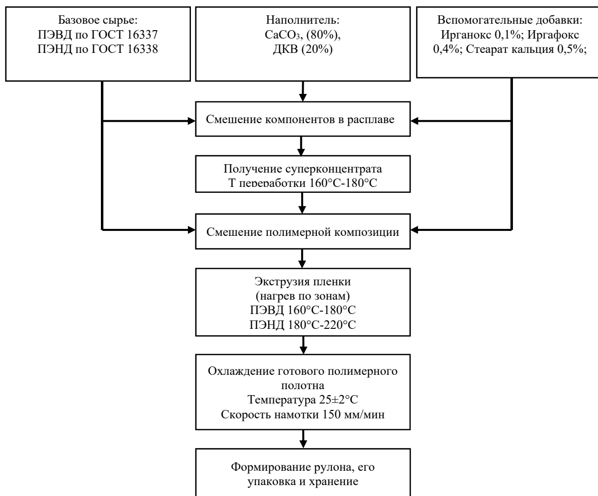
Рисунок 3.34 – Алгоритм получения ПЭВД и ПЭНД пленок, модифицированных \text{CaCO}_3 и ДКВ
