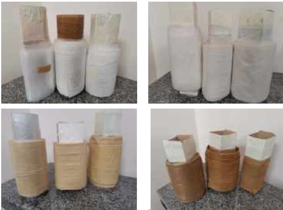
Рисунок 3.33. – Внешний вид образцов ПЭНД и ПЭВД пленок с \text{CaCO}_3 с концентрацией 20,0% и 40% и ДКВ с концентрацией 0,5% и 1,0%
