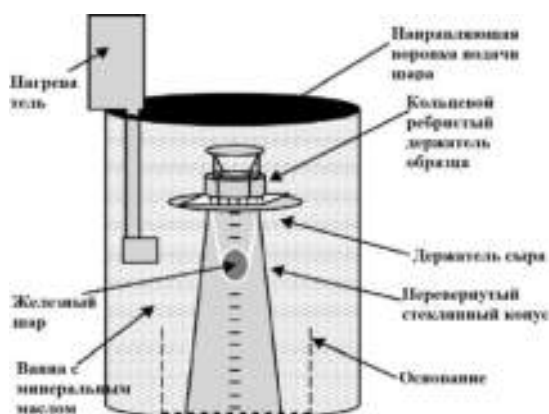
Рисунок 1.2 - Схема аппарата для определения способности сыра к растягиванию [108]
