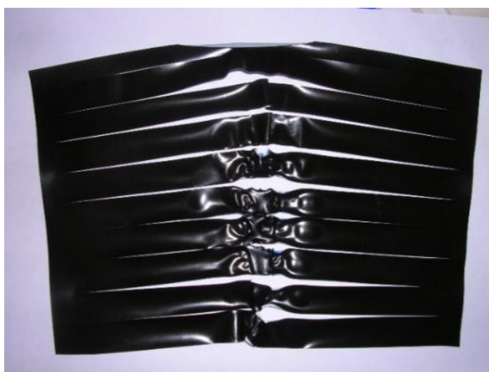
Рисунок 3.16 – Фотография УФ-облученной пленки LDPE с пищевой сажой
