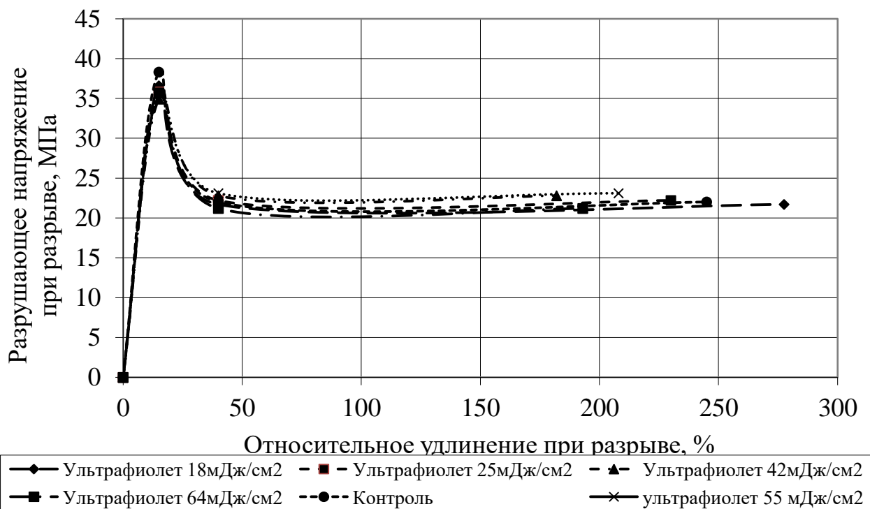
Рисунок 3.12 – Зависимость \sigma - \epsilon при разрыве образцов из PS ленты при различных режимах УФ-облучения
